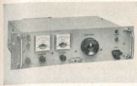
Nuovo alimentatore per corrente continua della HEWLETT PACKARD. Questo alimentatore completamente transistorizzato può fornire una tensione in uscita variabile da 0 a 60 V con un carico massimo di 2 A. La stabilizzazione della tensione è ottima: la variazione del carico da 0 a 2 A fa variare l'uscita meno di 5 mV, una variazione del 10% della tensione di alimentazione fa variare l'uscita meno di 2,5 mV. (g. b.)
