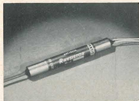
Questo relé elettro-ottico della RAYTHEON, impiegato soprattutto come potenziometro, permette di controllare una tensione nella gamma da 0 a 1,5 V e da 0 a 24 V rispettivamente nelle due esecuzioni CK 1102 e CK 1104. Ad una estremità del tubo è montata una sorgente luminosa costituente l'elemento di controllo; alla altra estremità è montato un elemento fotoconduttore la cui resistenza varia da 1 a 105 in funzione della tensione applicata all'elemento di controllo. (g. b.)
