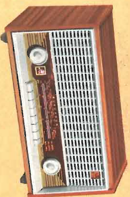
Ricevitore ES 61 (modulaz. di frequenza) - 6 Valvole - OM-OC-FM-Fono - Comandi a tastiera, regolazione multipla dei toni - Altoparlante mm. 125 - Potenza d'uscita 3,5 W. - Mobile in legno, frontale in plastica - Dimensioni: 41 x 19 x 22,5 - Peso: Kg. 3,800.
