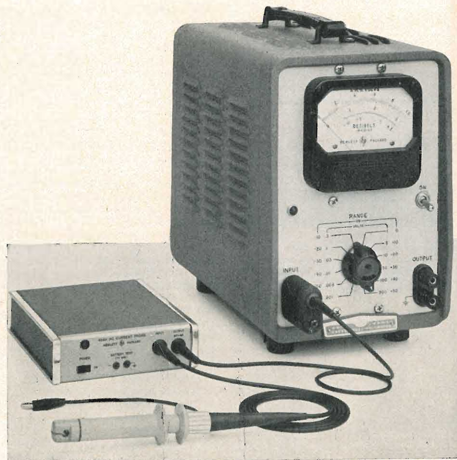
Fig. 11 - Il nuovo probe a pinza ed il suo amplificatore collegato ad un voltmetro a valvola.
