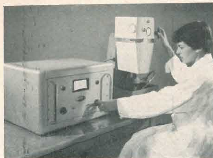
Un nuovo rettificatore rapido ad ultrasuoni della RAYTHEON è stato studiato principalmente per le lavorazioni di precisione necessarie nella fabbricazione dei semiconduttori e di altri elementi elettronici. Con questo trasduttore magnetostrittivo da 300 W, mod. 2-333, la RAYTHEON ha eliminato gli inconvenienti offerti dai trasduttori ceramici. (g. b.)
