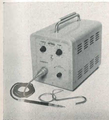
Anche i materiali « non saldabili » possono venire saldati con il nuovo dispositivo ad ultrasuoni della RAYTHEON, senza bisogno di flussi speciali. Gli ultrasuoni del nuovo dispositivo, emessi ad una frequenza di 25.000 Hz sotto forma di impulsi molto rigidi, rompono il film di ossido superficiale e permettono alla lega saldatrice di aderire perfettamente alla superficie. Con questo sistema si possono ora saldare facilmente l'alluminio, la ferrite, il silicio ed il germanio. (g. b.)
